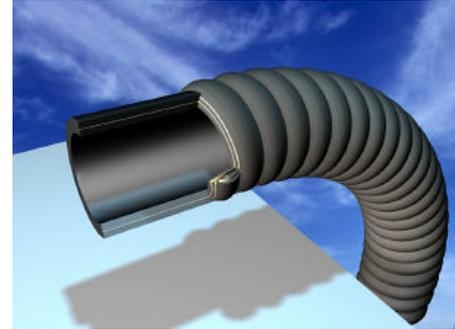
Рукава неармированные резиновые с текстильным каркасом и металлической спиралью в зависимости от назначения подразделяются на **классы**:
